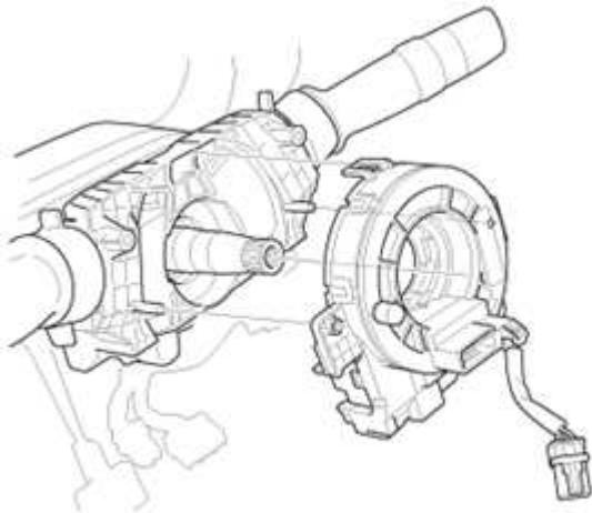
3. 线盘插接器 A、B 和转向角传感器插接器 - 连接
