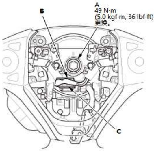
1. 安装新的方向盘螺栓 (A)。
